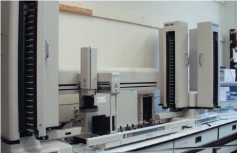
Abb. 4: Roboter, wie er von uns für automatisierte Two-hybrid-Screens verwendet wird.
